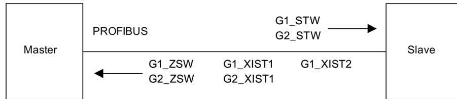
Figure 11-3 Example of encoder interface (encoder 1: Two actual values, encoder 2: One actual value)
